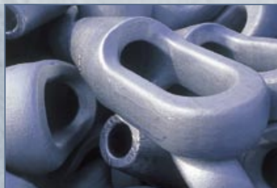
Oppervlakteruwheid geeft een onregelmatige zinklaag
